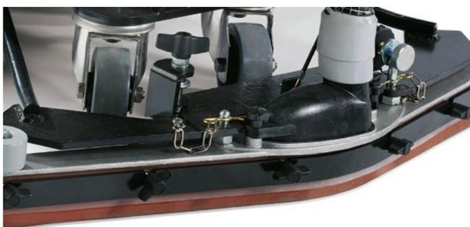
La boquilla de aspiración es fácilmente regulable respecto a la inclinación y a la presión de las gomas y está equipada con dos ruedas que dan estabilidad de funcionamiento. Las gomas pueden utilizarse por los dos lados.
