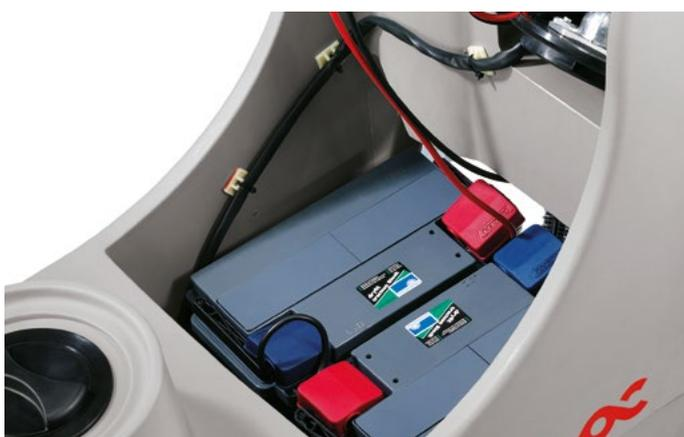
El receptáculo baterías, amplio y de fácil acceso puede alojar dos baterías de 12 V/90
