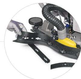
Las operaciones de sustitución y rotación de las gomas de la boquilla de aspiración se realizan en pocos instantes y no requieren el empleo de herramientas.
