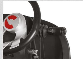
Cerca del volante, en una posición donde el operador pueda llegar cómodamente, se encuentra la palanca de avance/marcha atrás que permite elegir entre 3 velocidades de trabajo preconfiguradas.
