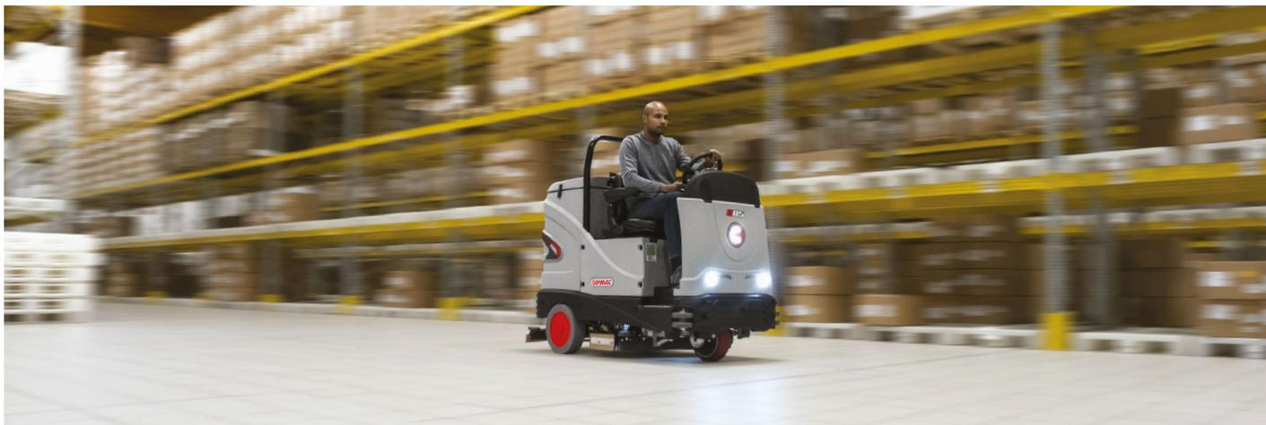
Operaciones de limpieza rápidas para optimizar el tiempo: hasta 8 km/h durante el trabajo. Un sensor continuo situado en el eje de dirección reconoce la posición exacta de la rueda de tracción delantera y reduce automáticamente la velocidad de la máquina según sea necesario. El sensor permite que la máquina avance suavemente y sin vacíos.
