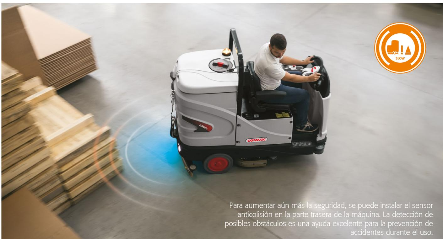
Para aumentar aún más la seguridad, se puede instalar el sensor anticolidión en la parte trasera de la máquina. La detección de posibles obstáculos es una ayuda excelente para la prevención de accidentes durante el uso.
