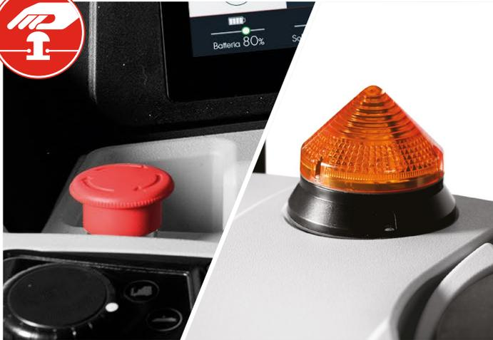
Emergency Stop. En caso de emergencia, sólo hay que pulsar un botón para que el avance y todas las funciones se bloqueen de inmediato. El intermitente ayuda a que la máquina esté visible durante el trabajo y el zumbador avisa acústicamente de que la máquina se está moviendo marcha atrás.
