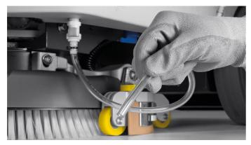
El agua del tanque de solución también se descarga de forma práctica y rápida gracias al tubo de descarga específico que se puede enganchar en la parte delantera de la fregadora de pavimentos.
