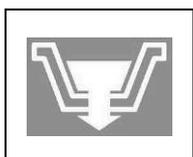
Símbolo que indica la posición del tubo de descarga del depósito solución.
