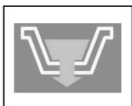
Símbolo que indica la posición del tubo de descarga del depósito recuperación.
