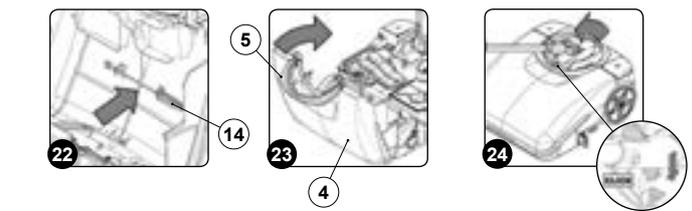
30. Girar la palanca de retención del manillar de mando (16) en el sentido de rotación indicado por la flecha (Fig. 22).
