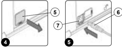
**PRUDENCIA:** Antes de enchufar la clavija (6) en la toma (7), controlar que no haya suciedad (polvo, condensación u otros tipos de líquidos) en el compartimento que alojará la clavija del cargador de batería.
